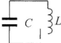
$\begin{cases} q(t) = q_{\max} \sin(\omega t + \phi_0) \\ I(t) = \dot{q}_t = \omega q_{\max} \cos(\omega t + \phi_0) = I_{\max} \cos(\omega t - \phi_0) \end{cases}$ $\text{Формула Томсона: } T = 2\pi \sqrt{LC}, \text{ откуда } \omega = \frac{2\pi}{T} = \frac{1}{\sqrt{LC}}.$ |
